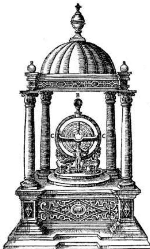
Het veelbesproken „perpetuum mobile” van Drebbel berustte op de uitzetting van lucht.
